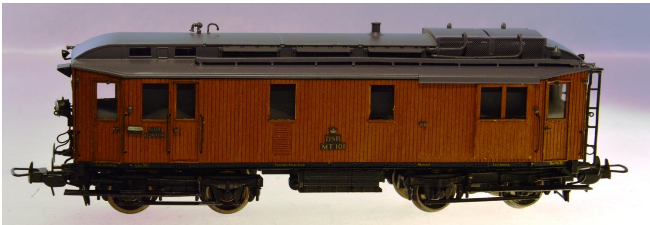
Den ene side af MT 101. Her er masser af fine detaljer i støbte og ætsede metaller alle håndbøjler er ligeledes i metaltråd – fine sager!
